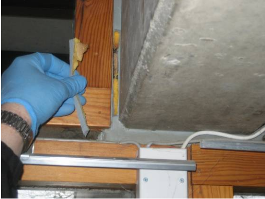
Figur 2-1 Eksempel på indvendigt udtaget PCB-holdig elastisk fuger 173
